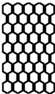
Рисунок В.2 – Вид на пакет пластин при правильной сборке
