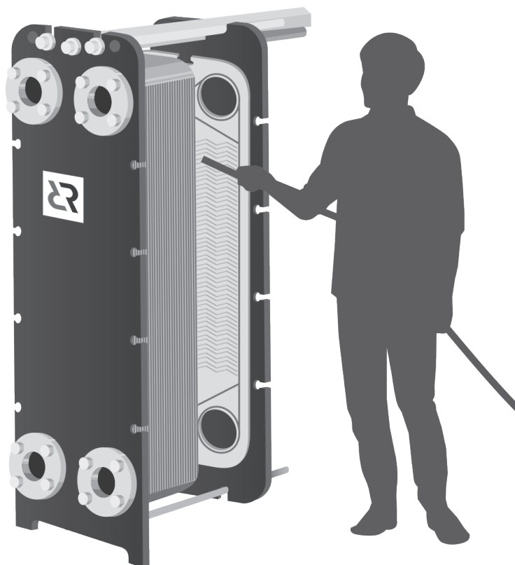
Рисунок В.1 – Схема очистки теплообменника водой под давлением и щеткой
