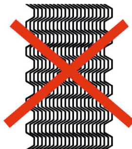
Вид пакета пластин при неправильной сборке
