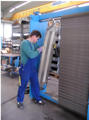
Рис 6.4. Демонтаж пластины с нижней направляющей.
