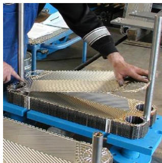
Рис 6.13. Сборка маленьких типоразмеров теплообменников
