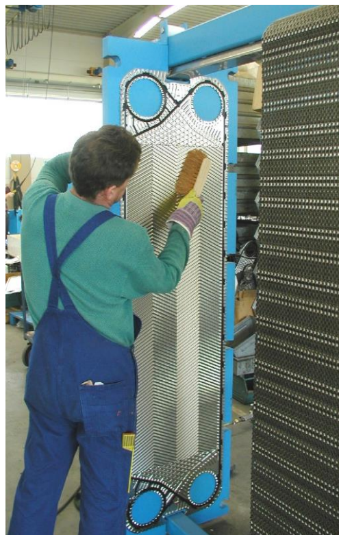
Рисунок 6.6. Очистка поверхности пластины с помощью мягкой щетки.
