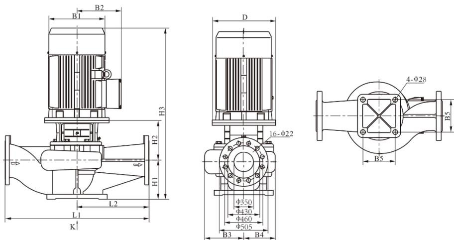
Рисунок 20л. Габаритно-присоединительные размеры модели TD(I)350
