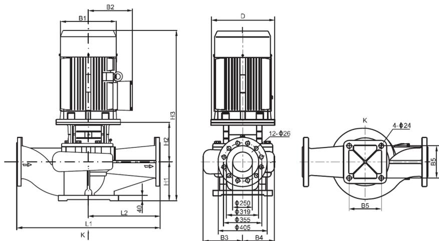
Рисунок 19п. Габаритно-присоединительные размеры моделей TD250
