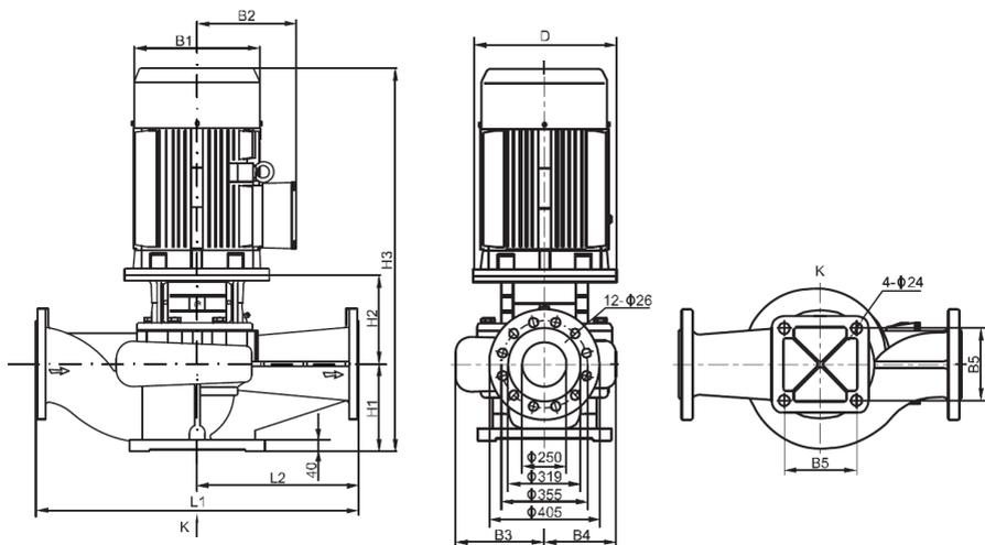
Рисунок 19о. Габаритно-присоединительные размеры моделей TD250
