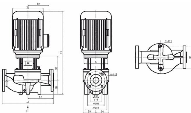
Рисунок 20б. Габаритно-присоединительные размеры модели TD32-10(I)/2
