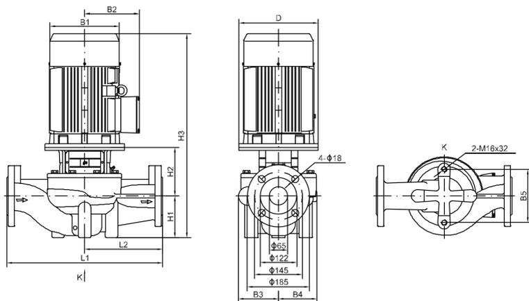
Рисунок 19е. Габаритно-присоединительные размеры моделей TD(G)65
