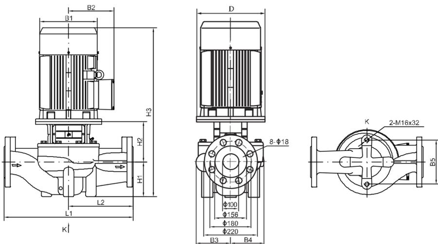
Рисунок 19и. Габаритно-присоединительные размеры моделей TD/TD(G)100
