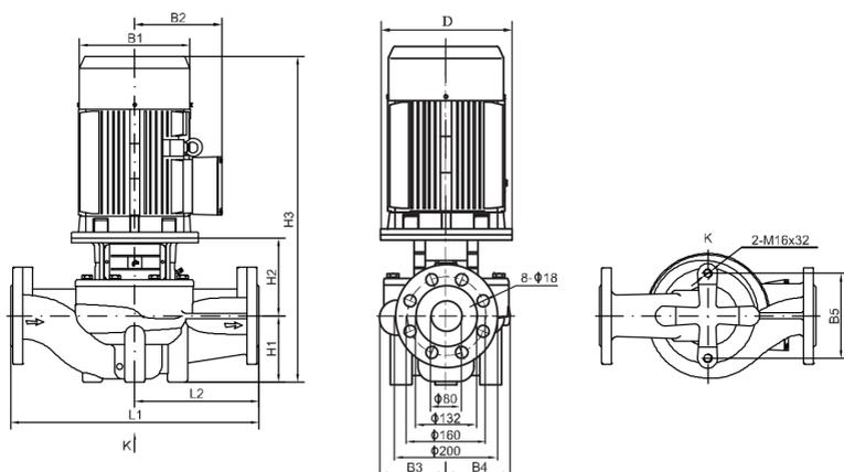
Рисунок 19ж. Габаритно-присоединительные размеры моделей TD(G)80
