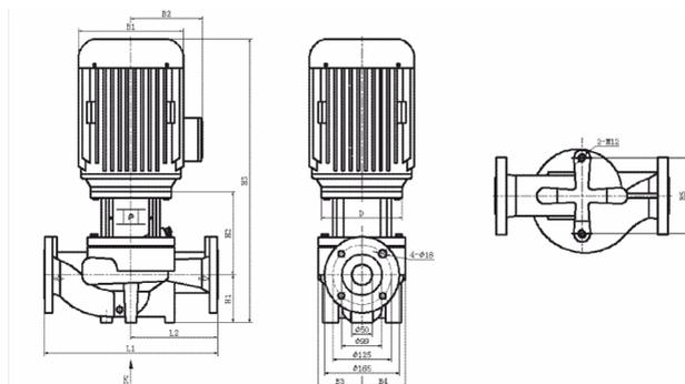
Рисунок 20д. Габаритно-присоединительные размеры модели TD50-6(I)/2, TD50-11(I)/2
