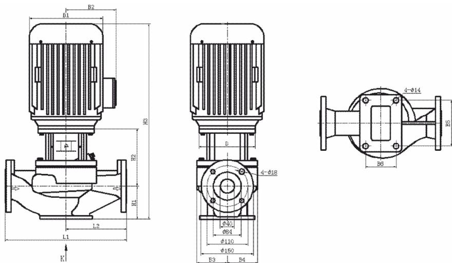
Рисунок 20г. Габаритно-присоединительные размеры модели TD(I)40
