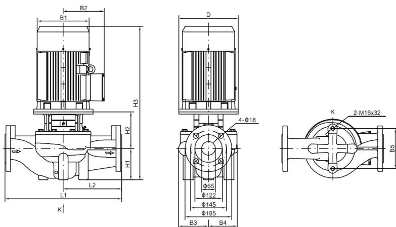
Рисунок 19д. Габаритно-присоединительные размеры моделей TD(G)65
