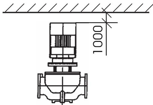
Рис. 10 Электродвигатель  $> 5$  кВт
