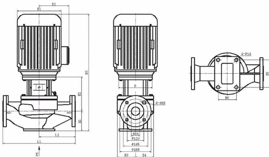
Рисунок 20ж. Габаритно-присоединительные размеры модели TD(I)65
