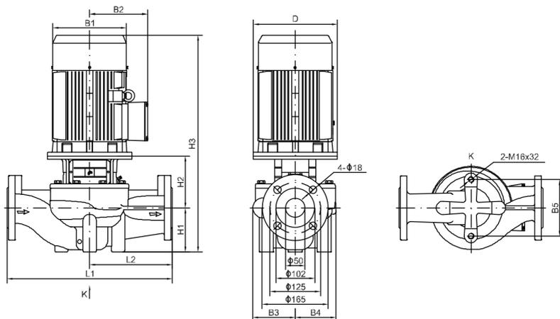
Рисунок 19г. Габаритно-присоединительные размеры моделей TD(G)50
