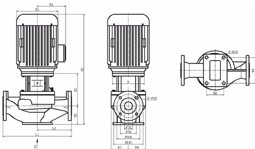
Рисунок 20в. Габаритно-присоединительные размеры модели TD32-12,5(I)/2, TD32-15(I)/2
