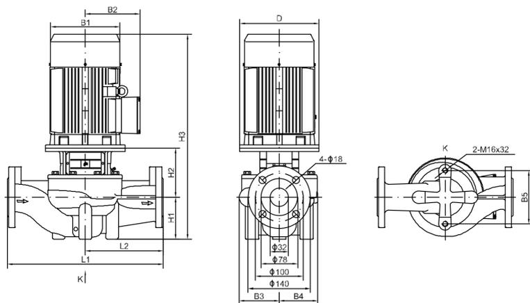
Рисунок 19а. Габаритно-присоединительные размеры моделей TD(G)32
