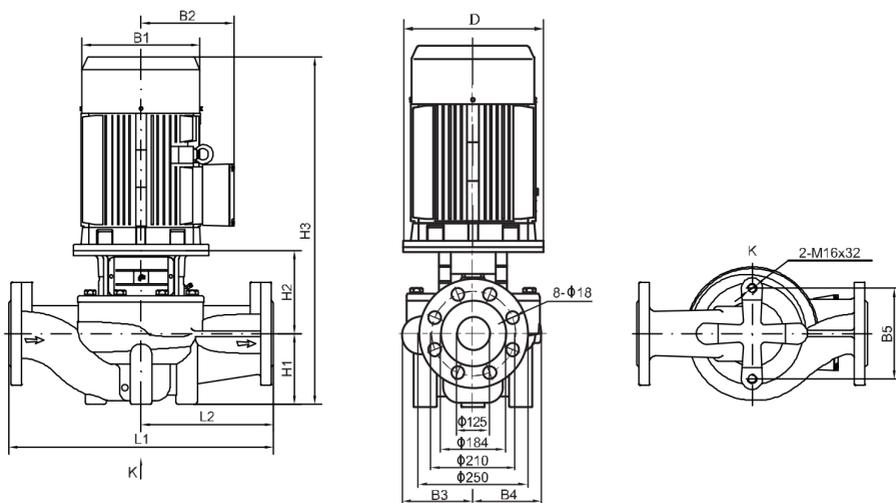
Рисунок 19к. Габаритно-присоединительные размеры моделей TD(G)125
