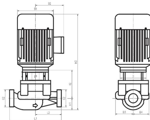
Рисунок 20а. Габаритно-присоединительные размеры модели TD32-6(I)/2
