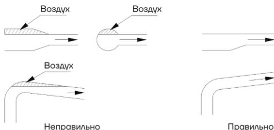
Рис. 13 Правильный монтаж трубопроводов
