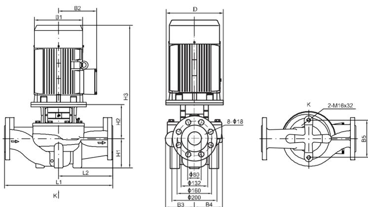
Рисунок 19з. Габаритно-присоединительные размеры моделей TD(G)80
