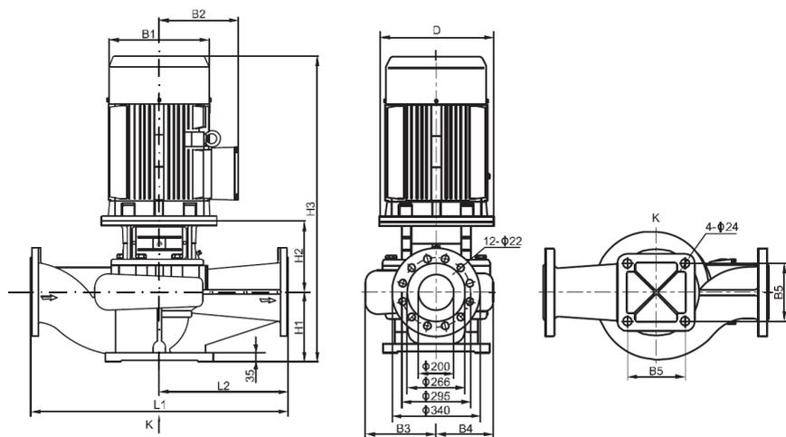
Рисунок 19м. Габаритно-присоединительные размеры моделей TD200
