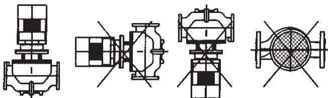
Рисунок 8 Варианты установки > 2,2 кВт
