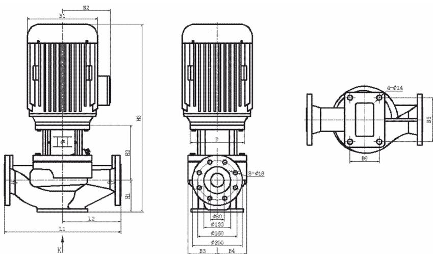
Рисунок 20з. Габаритно-присоединительные размеры модели TD(I)80
