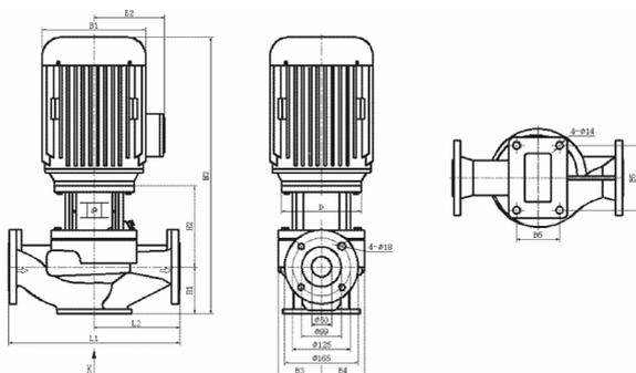
Рисунок 20е. Габаритно-присоединительные размеры модели TD50-8(I)/2, TD50-12,5(I)/2
