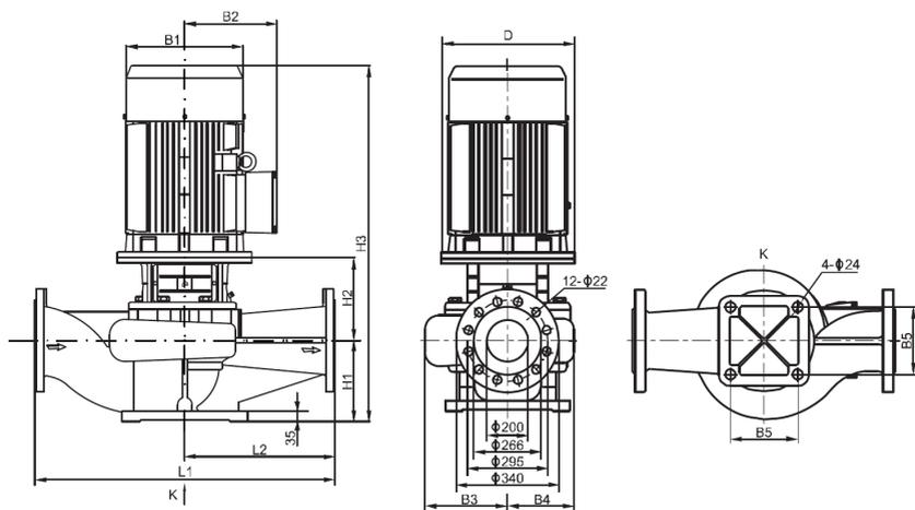
Рисунок 19н. Габаритно-присоединительные размеры моделей TD200
