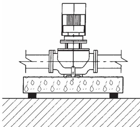
Рис. 11 Установка насоса на фундаменте
