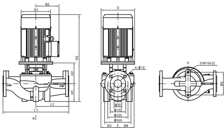
Рисунок 19в. Габаритно-присоединительные размеры моделей TD(G)50
