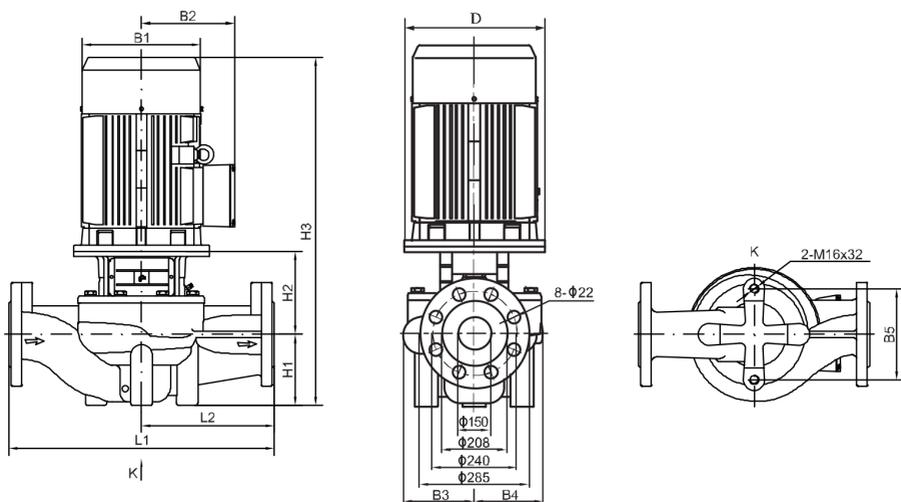
Рисунок 19л. Габаритно-присоединительные размеры моделей TD/TD(G)150
