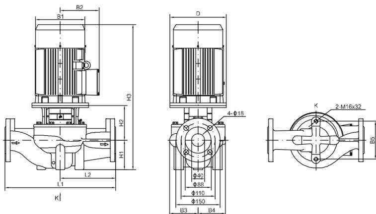
Рисунок 196. Габаритно-присоединительные размеры моделей TD(G)40
