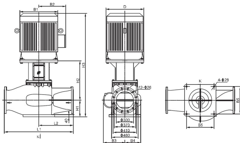
Рисунок 19р. Габаритно-присоединительные размеры моделей TD300
