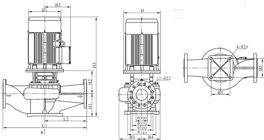
Рисунок 20к. Габаритно-присоединительные размеры модели TD(I)300
