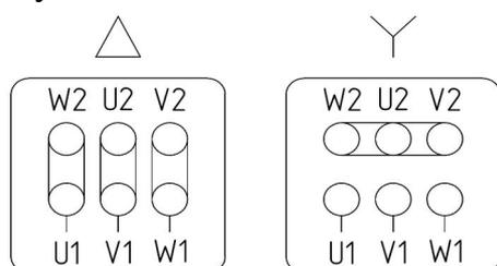
Рисунок 4. Схема подключения фаз электропитания.
