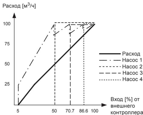
Рис. 30 Регулировочная характеристика для MPC-F в разомкнутом контуре
