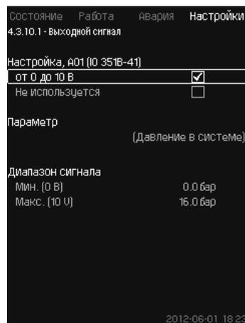
Рис. 86 Выходной сигнал
