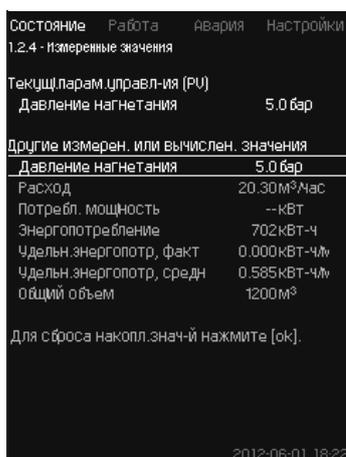
Рис. 17 Измеренные значения
