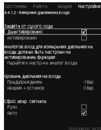
**Рис. 105** Измерение давления на входе
