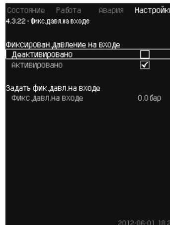
Рис. 97 Фикс. давл. на входе
