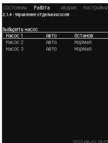
Рис. 33 Управление отдельн.насосом
