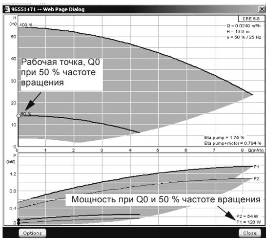
Рис. 94 Показание мощности при Q0 и 50 % частоте вращения
