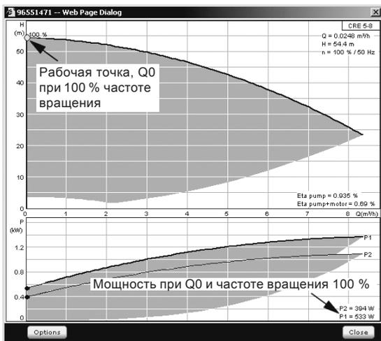
Рис. 93 Показание мощности при Q0 и 100 % частоте вращения
