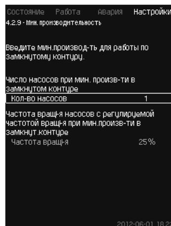
Рис. 66 Мин. производительность
