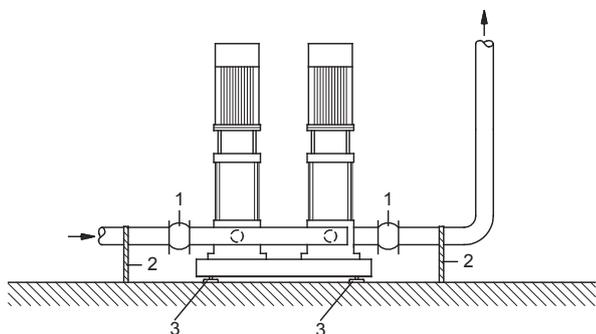
Рис. 6 Положение вибровставок, опор для труб и вибрационных опор
