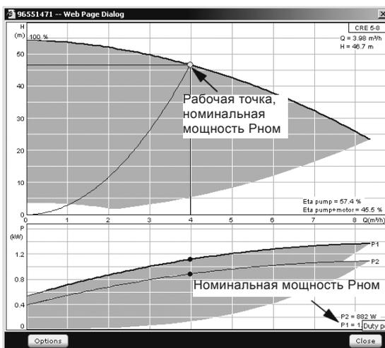
Рис. 95 Показание номинальной мощности P<sub>ном</sub>
