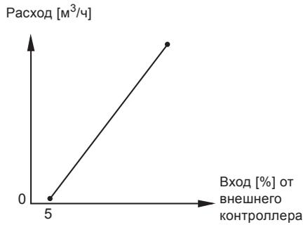
Рис. 28 Регулировочная характеристика для разомкнутого контура
