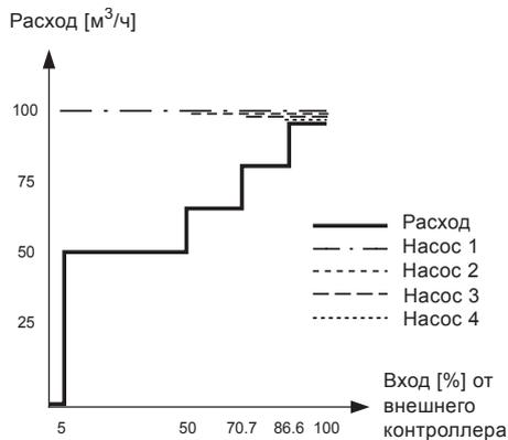
Рис. 31 Регулировочная характеристика для MPC-S в разомкнутом контуре
