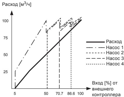
Рис. 29 Регулировочная характеристика для MPC-E в разомкнутом контуре
