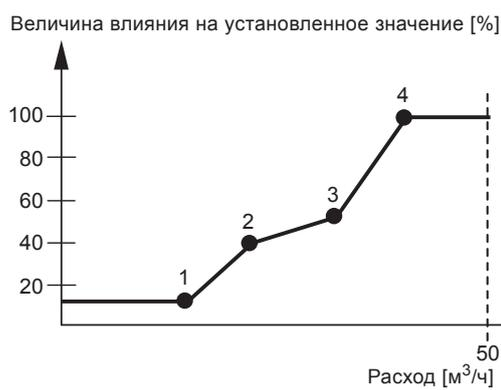
Рис. 47 Соотношение между влиянием на установленное значение и расходом
