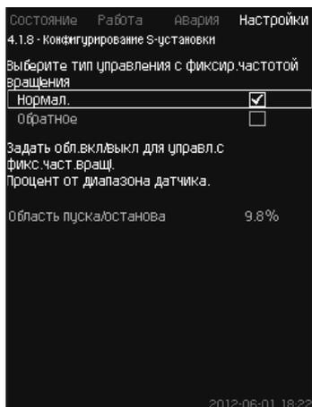
Рис. 54 Конфигурирование S-установки
